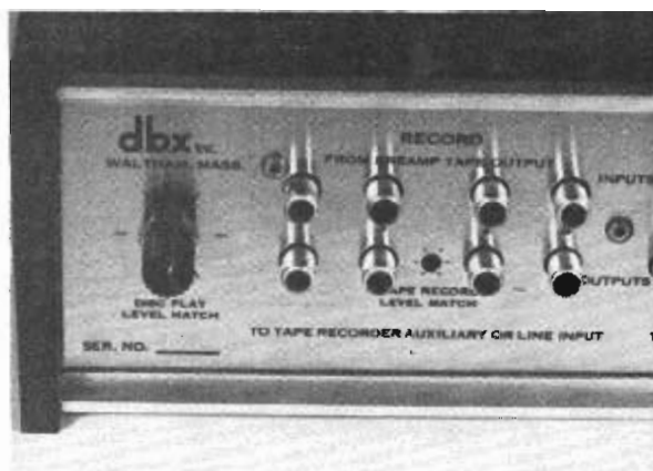
DBX 124 - Peu de réglage pour le 124 : Niveau de lecture et d'enregistrement.
