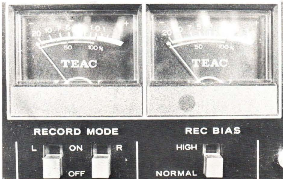
Ci-dessus, vu-mètres et commandes d'enregistrement et de niveau de prémagnétisation
