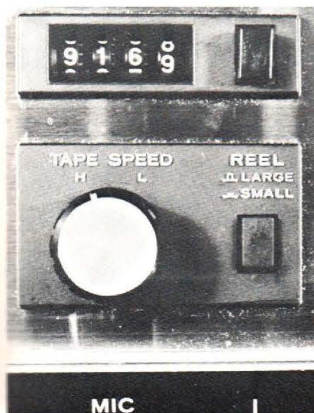
Ci-dessous, compteur à quatre chiffres, commande de changement de vitesse et sélection de diamètre des bobines.
