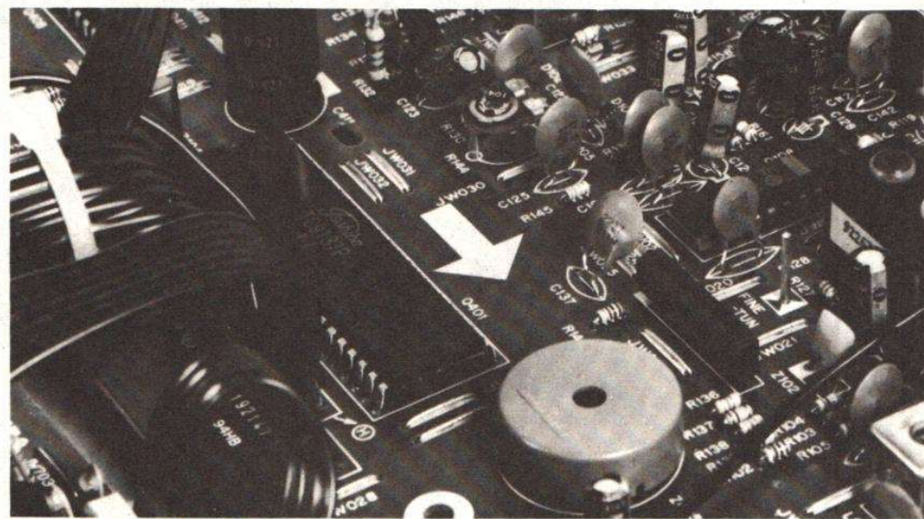
Le circuit de synthèse et de gestion et le résonateur céramique de « bip, bip ».
