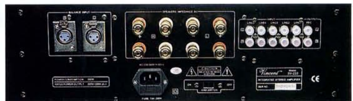
La face arrière comporte deux jeux de grosses bornes de sortie câblés en parallèle
