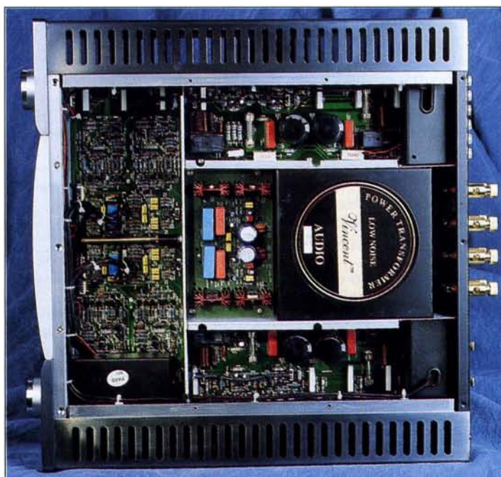
Soigneusement délimité par des cloisons et blindages, l'intérieur est rationnel et... symétrique !
