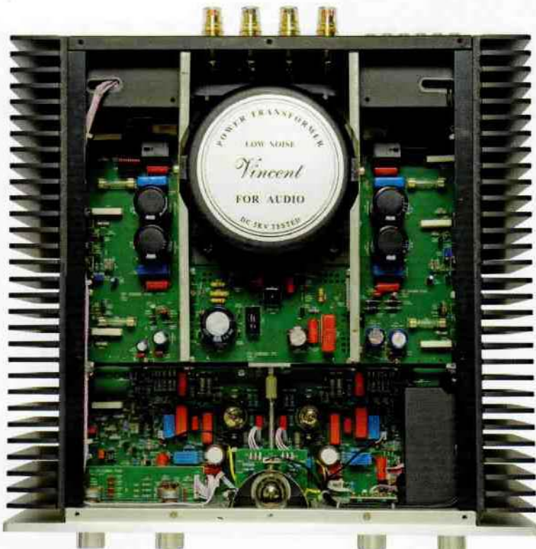
On appréciera la belle implantation véritablement double mono, et la présence d'un transformateur torique totalement blindé.
